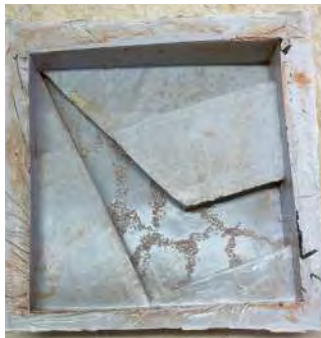
Taller de Moldes: Extracción del barro y molde negativo
