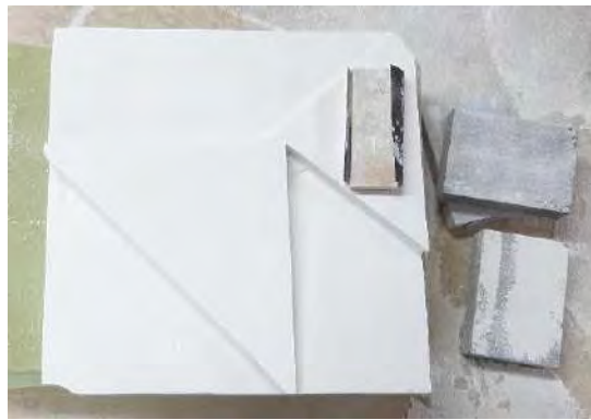
Taller de Molde: repasado, lijado y acabado final de la pieza
