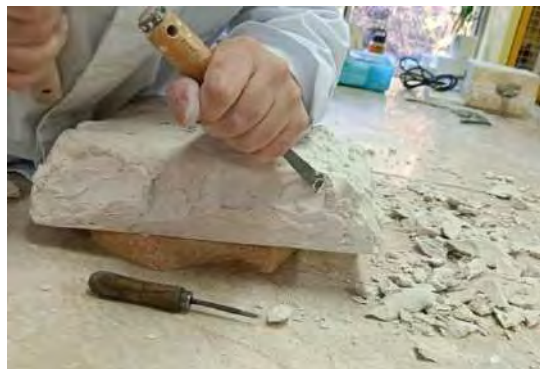
Taller de Moldes: picado del molde y extracción del modelo
